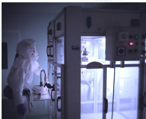
Chambre d'essai de 2,5 m<sup>3</sup> pour tester les performances d'épurateurs d'air vis à vis de virus (VirexpR)
