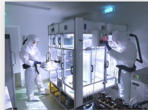
Chambre de petit volume (2,5 m 3 ) pour tester les performances de systèmes de dépollution d'air
