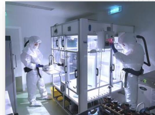
*Chambre de petit volume (2,5 m<sup>3</sup>) pour tester les performances de systèmes de dépollution d'air*
